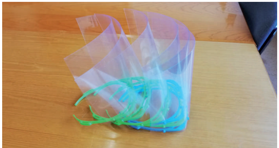
Osasungintzako langileentzako aurpegirako babesgarriak egiten ari dira lanbide eskolatan: 3D inprimagailuetan egindako diademai plastikozko babesgarria lotzen diete.
