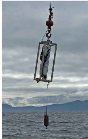
Εικ.2.3 Αριστερά, πόντιση CTD profiler από το ΥΓ/ΩΚ Ναυτίλος του Πολεμικού Ναυτικού. Δεξιά, πόντιση CTD profiler από το Κέντρο Επιστημών της Αλάσκα (Alaska Science Center) της υπηρεσίας United States Geological Survey στο απαιτητικό περιβάλλον της Αλάσκας.
