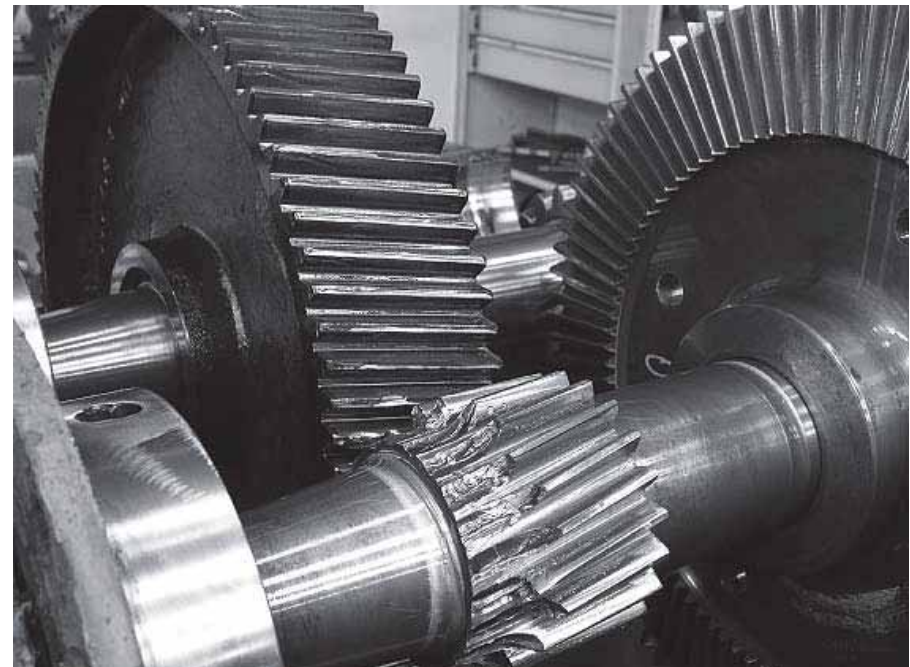
Gewaltbruch am Zahnfuß (Verformungsbruch)
