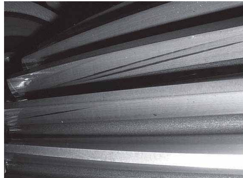
Stillstandsmarkierung bei einer Schrägverzahnung
