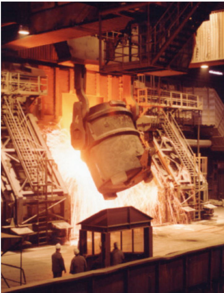
Abbildung 6: Das Foto zeigt den Konverter in Füllstellung, beim Befüllen mit dem flüssigen Roheisen.
