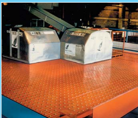
Zařízení letiště pro manipulaci s AIR CARGO hliníkovými kontejnery
