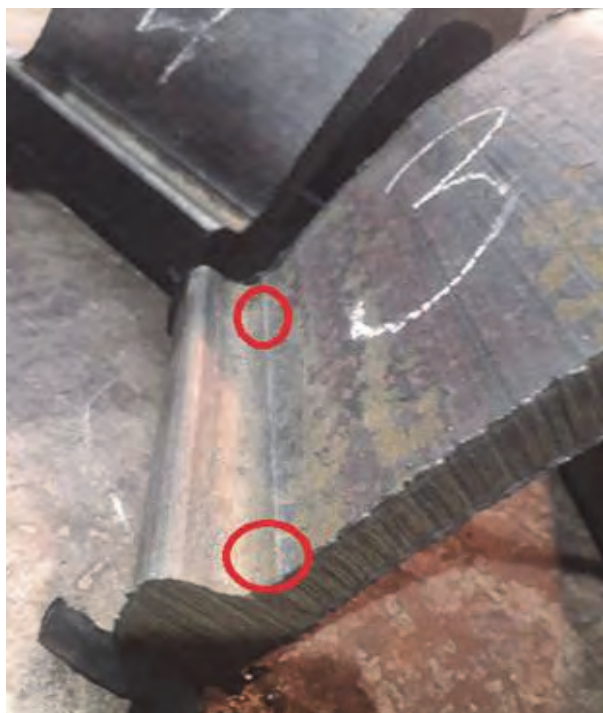
Obr. 3 Nežádoucí lem na bocích vývalků Fig. 3 Unwanted defect on the sides of profiles
