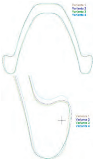
Obr. 5 Srovnání jednotlivých variant tvaru rozvalku vstupujícího do 9. stolice, nahoře celkový průřez, dole detail patky
