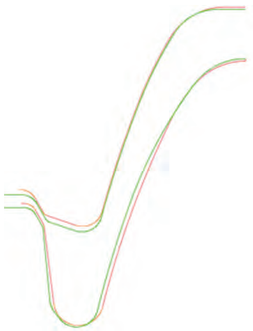
Obr. 13 Stolice 7: Původní (zelený) kalibr a nový tvar kalibru (červený) Fig. 13 Stand 7: Original (green) grooves and new grooves shape (red)
