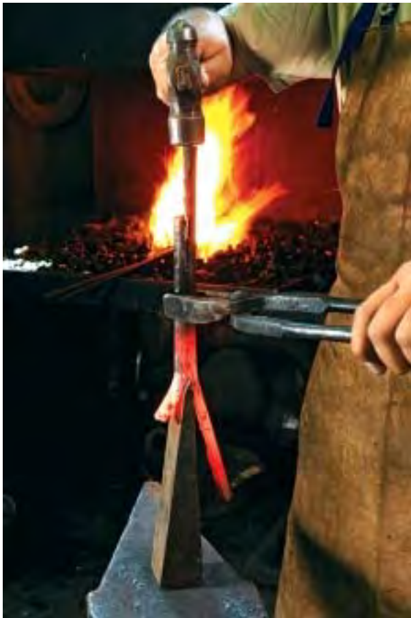
Obr. 4 Jeden ze způsobů štěpení konce výkovku
