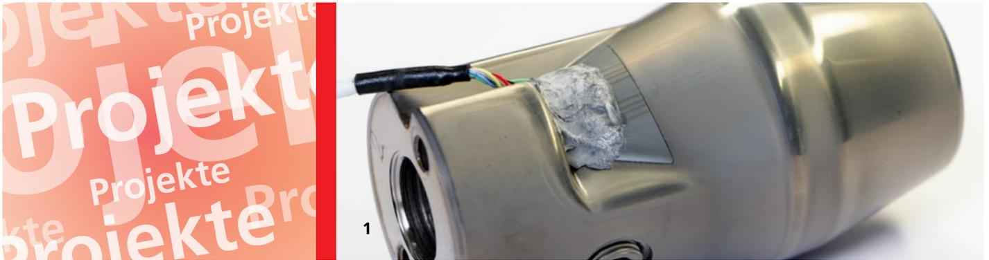
1 Formkern mit angelöteten Messdrähten an den zwei Sensorstrukturen. Der Lötbereich wurde versiegelt, sodass auch bei Temperaturen über der Schmelztemperatur des bleifreien Lötzinns Messungen möglich sind.
