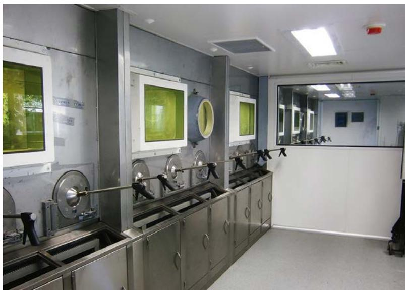
**7** Las celdas calientes nuevas para la fabricación de tecnecio 99m cumplen los requisitos pertinentes de las buenas prácticas de manufactura. Para el exterior de la celda se usó acero inoxidable y las paredes, el suelo y el techo reúnen las condiciones de limpieza farmacéutica requeridas. Al final del corredor, una trampilla de transferencia (ventana) conecta con otro laboratorio en el que se produce yodo 131.
