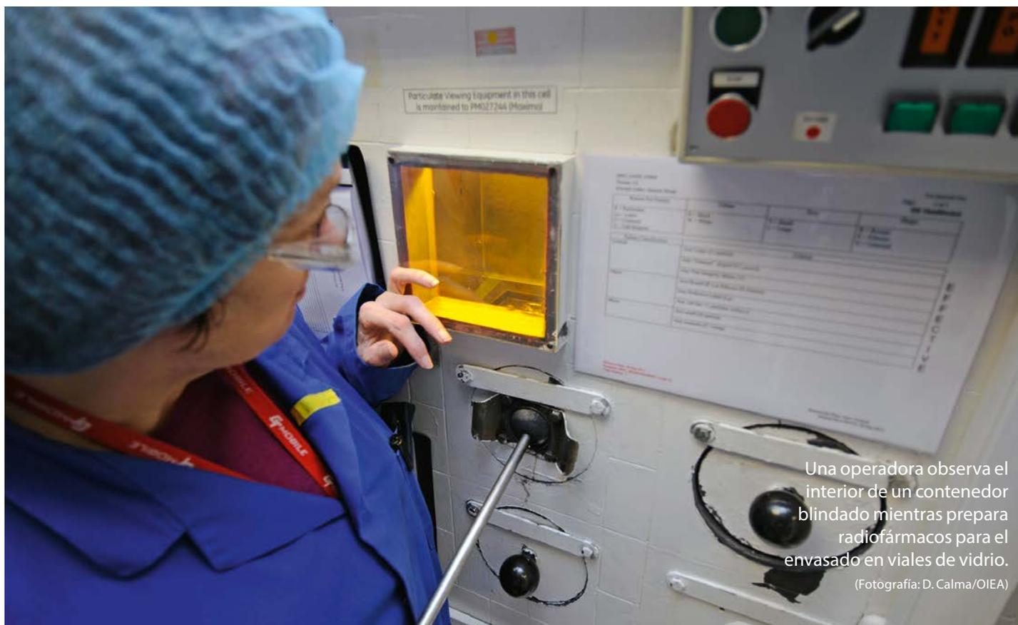
Una operadora observa el interior de un contenedor blindado mientras prepara radiofármacos para el envasado en viales de vidrio.
