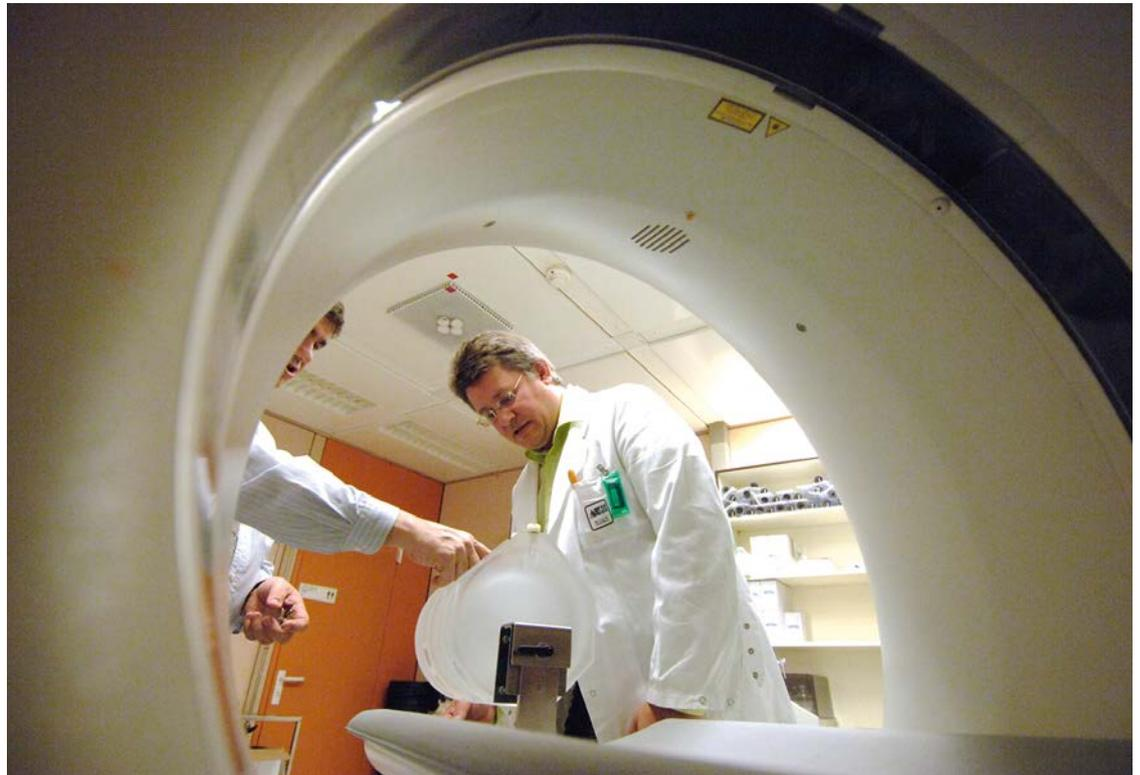
Físico preparando un simulador o modelo de cabeza para las mediciones de los resultados de un aparato de diagnóstico por imagen.
