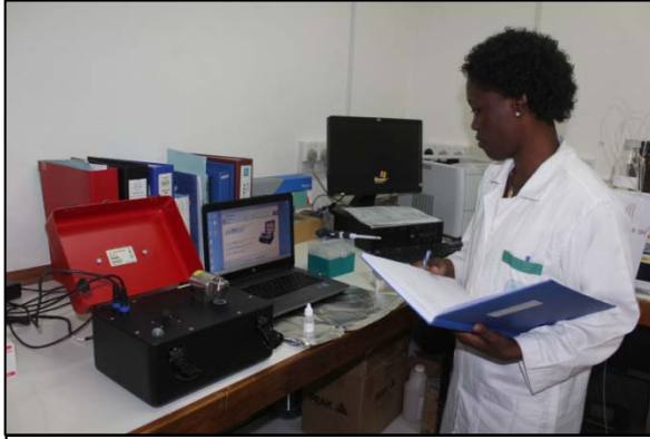
المشروع SEY/6/003: تحليل إثراء الديوتيريوم باستخدام تنظير الطيف بالأشعة تحت الحمراء باستخدام تحويل فورييه.
