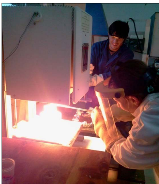
المشروع ARG/9/013: عملية صهر الزجاج في فرن كهربائي كجزء من البحث بشأن التخلص الآمن من النفايات المشعة، مختبر المواد النووية، المركز الذري لباريلوش. الهيئة الوطنية للطاقة الذرية.
