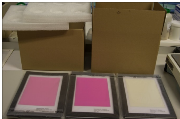
المشروع RER7008: اختبار للكفاءة في إطار المشروع RER7008: شحنة من المواد المرجعية الجديدة المحتوية على نويدات مشعة المتجانسة الطباعة باستخدام طابعات حريرية على صحائف ورقية (يرمز كل لون لنويده مشعة مختلفة). الصورة من ساندور تارجان/الوكالة.
