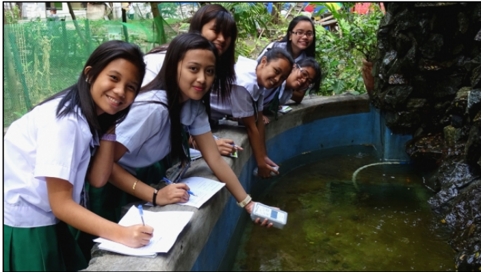
المشروع RAS0065: طلاب في الفلبين يقيسون الإشعاع الطبيعي باستخدام جهاز 'Hakaru-Kun'، وهو مقياس مسح سهل الاستخدام تم تطويره للأغراض التعليمية. الصورة من: ت. إيموتو/جامعة طوكيو.
