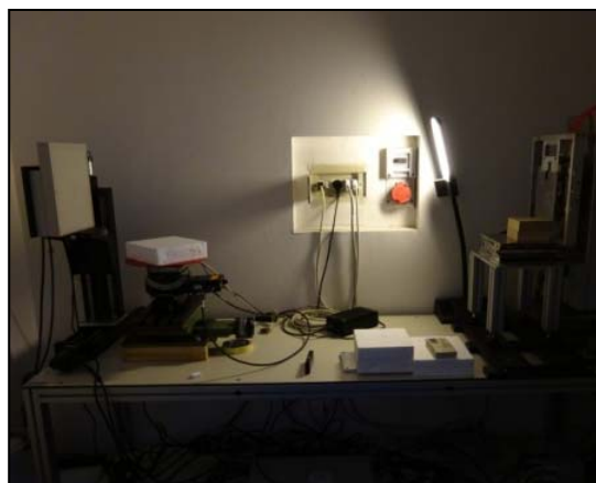
المشروع MAT0002: التصوير المقطعي الحاسوبي باستخدام نظام التصوير المقطعي الحاسوبي المتوسط الحجم (يساراً) ونظام التصوير المقطعي الحاسوبي المستخدم للأجسام الكبيرة (يميناً). الصورتان من: م. غريما/تراث مالطة.
