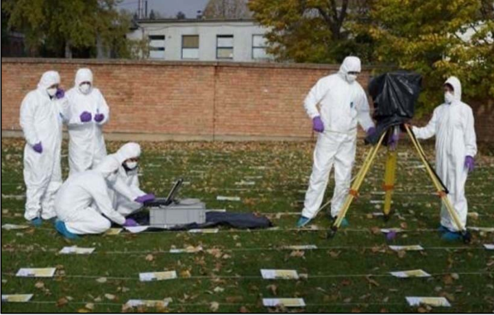
المشروع: RER7008: تركيب مقياس طيف أشعة غاما في الموقع في موقع ملوث بالمحاكاة. الصورة من: إس. تارجن/الوكالة الدولية للطاقة الذرية.
