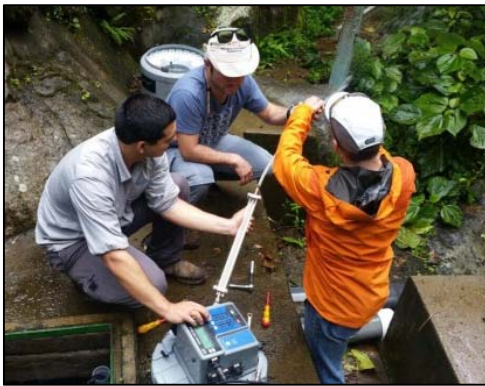
المشروع COS7005: إعداد العينات لتحليل الغازات الخاملة الموجودة في مياه النبع. الصورة من: ل. كاسترو/ESPH.
