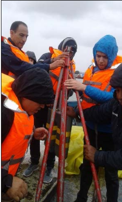
المشاركون وهم يقومون بتحضير المقياس النووي لقياس الترسيب. الصورة من: راينهاردت بنزون/جامعة بنما التكنولوجية.
