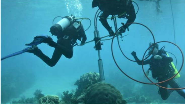
استخراج عينة اسطوانية من المرجان عمرها 230 سنة لأغراض محاكات التقلبات التاريخية لبدائل درجات الحموضة والحرارة باستخدام تقنية دلتا البورون-11 وتقنية الأكسجين-18، على التوالي. (الصورة من: لويس أنغال أراغون لوبيز/مركز سينيفويغوس للدراسات البيئية-كوبا)
