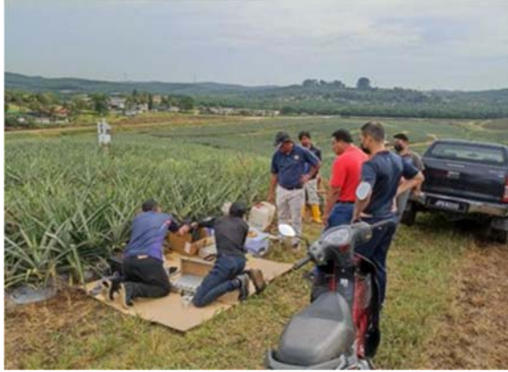
تركيب جهاز لاستشعار نيوترونات الأشعة الكونية ومعايرته والتحقق منه في مزرعة للأناناس تابعة لشركة كوليم. (الصورة من: موقع الدراسة في سيلاغور)
