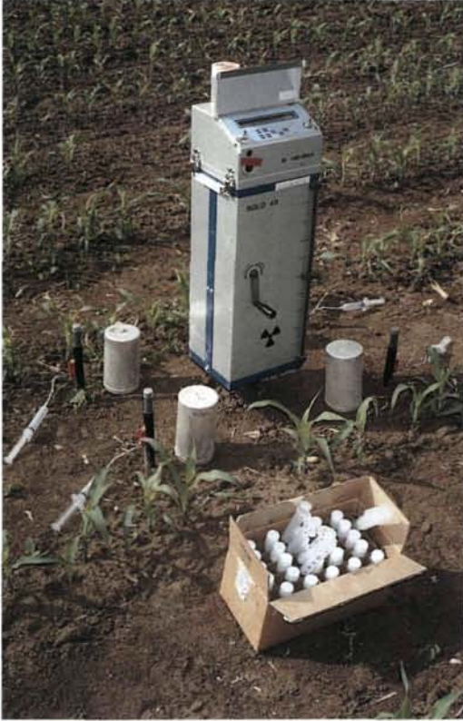
A partir du haut dans le sens horaire: Humidimètre à neutrons servant à mesurer la teneur en eau des sols; M. Hans Blix, directeur général de l'AIEA (deuxième à partir de la gauche), et M. J. Diouf, directeur général de la FAO (au centre), suivent avec leur groupe les explications de l'auteur lors de la Conférence de l'AIEA sur l'emploi des techniques nucléaires et apparentées pour l'étude du sol et des cultures; Mme Helga Axman, de la section de pédologie FAO/AIEA, parmi des participants à un cours régional de formation au Ghana; participants à un cours régional de formation sur l'emploi des isotopes pour l'étude des relations sol-plante, organisé à Bangkok en 1995.
