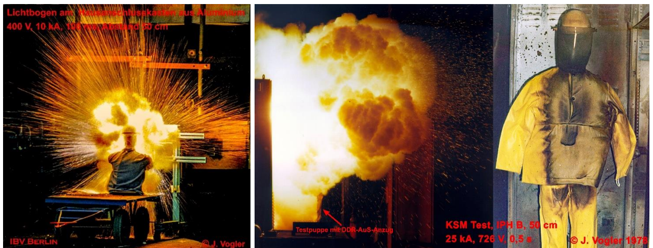
Bilder 30 und 31: Funkenflug und Rauchgasbildung bei realen Lichtbogenversuchen.
