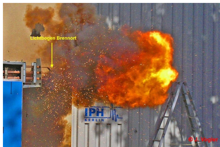
Bild 29: Rauchgaswolke 42 ms nach Abschaltung des Stromes 10 kA bei einer Spannung von 726 V
