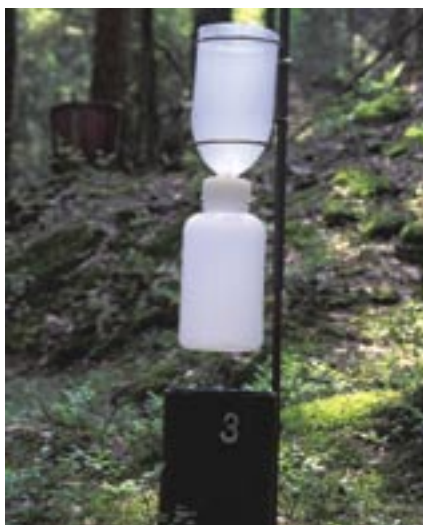
Εξοπλισμός μέτρησης για τη συλλογή των υγρών αποθέσεων στις δασικές συστάδες
