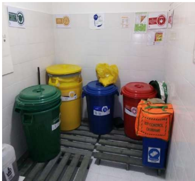
Falta de ventilación, se encuentran ubicados residuos peligrosos y no cuenta con extintor.
