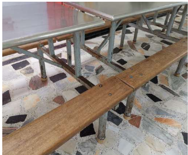
Mesas del comedor con presencia de oxido
