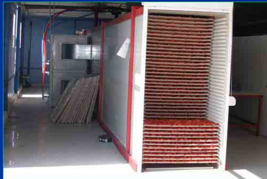
Γ/θ ξηραντήριο τομάτας τύπου σήραγγας στο Ν. Εράσμιο Ξάνθης
