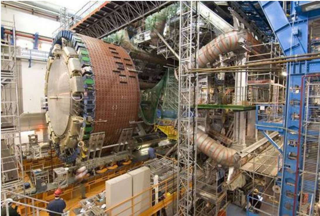
Una vista de la caverna de ATLAS en marzo de 2006. El "barril" de TileCal construido en IFAE es el cilindro marrón en la izquierda, y se está colocando dentro de los recipientes de vacío del imán toroidal, fabricadas en España. Dos de los recipientes se ven en la derecha (con tiras marrones); los recipientes albergan las bobinas superconductoras del imán.
