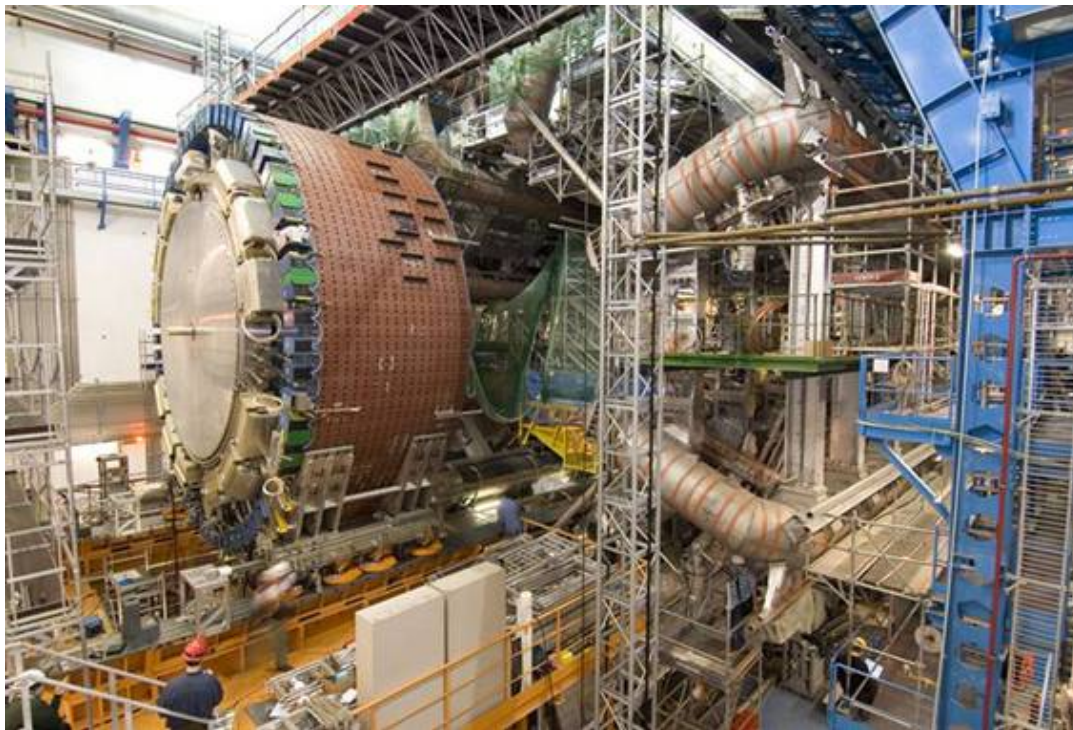
Una vista de la caverna de ATLAS al març del 2006. El "barril" de TileCal construït a IFAE és el cilindre marró a l'esquerra, i s'està col·locant dintre dels recipients de buit de l'imant toroidal, fabricats a Espanya. Dos dels recipients es veuen a la dreta (amb tires marrons); els recipients s'alberguen les bobines superconductoras de l'imant.
