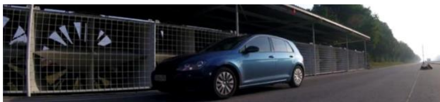
Abbildung 4-12: Versuchsfahrzeug vor der Seitenwindanlage (BMW Aschheim).
