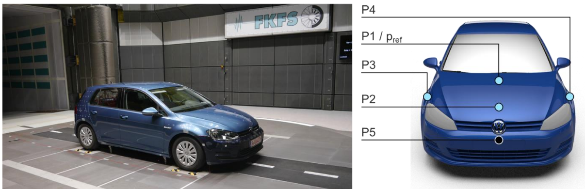
Abbildung 4-3: Versuchsfahrzeug bei der Kalibrierung im Aeroakustik-Windkanal der Universität Stuttgart (links) und die bei der Vorderwagen-Kalibrierung verwendeten Oberflächendruckmessstellen (rechts) [2].
