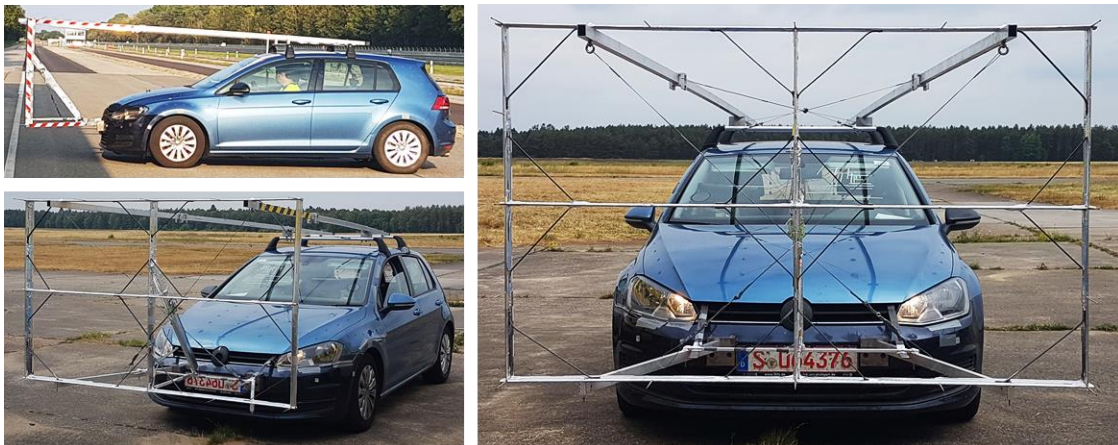
Abbildung 4-4: Versuchsfahrzeug mit 1 m vor der Front montiertem 2D-Array – bestehend aus 11 Fünflochsonden.
