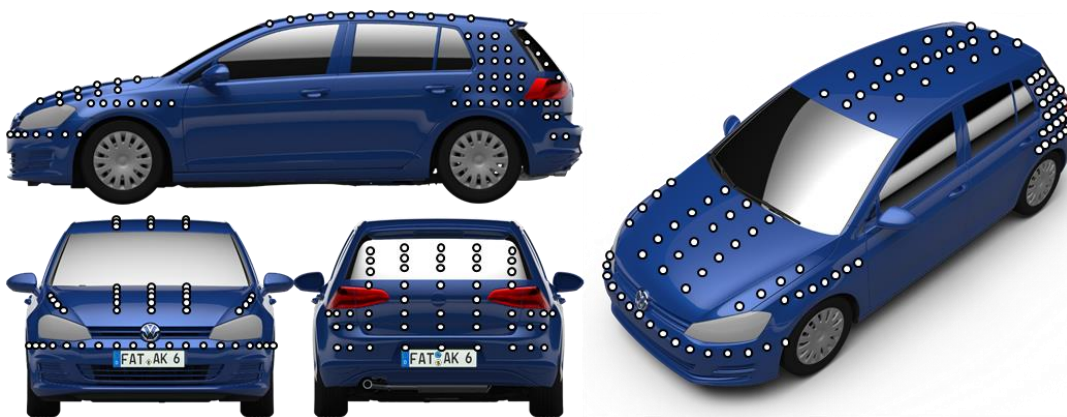
Abbildung 4-2: Verteilung der Oberflächendruckmessstellen auf dem Versuchsfahrzeug [2].
