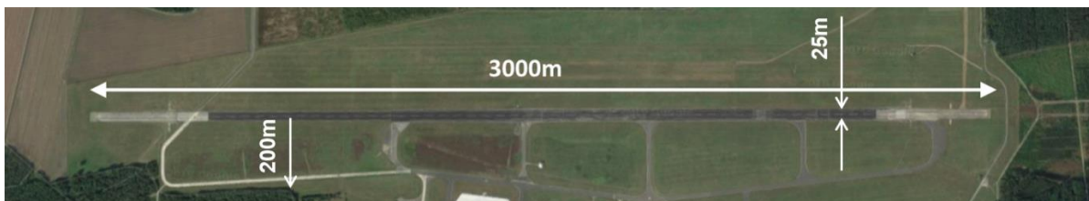
Abbildung 4-8: Satellitenansicht der als Teststrecke genutzten Landebahn mit den zugehörigen Rollwegen beim DLR Trauen mit einer Länge von 3 km und 25 m Breite sowie mindestens 200 m direkt angrenzendem flachen Rasenbewuchs [50].
