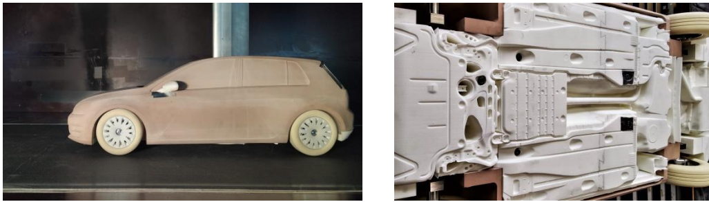
Abbildung 4-22: Links: 1:4-Modell des Versuchsfahrzeugs der SWG mit Laufband und Modellhalterung am Dach. Rechts: Detaillierter Unterboden des Fahrzeugmodells.
