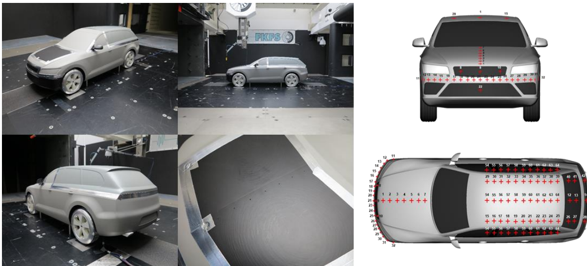
Abbildung 4-16: Verschiedene Ansichten des AeroSUV im Modellwindkanal der Universität Stuttgart (links) und die Verteilung der Oberflächendruckmessstellen auf dem Fahrzeugmodell (rechts).
