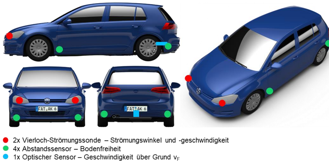
Abbildung 4-1: Positionierung der Vierloch-Strömungssonden, der Abstandssensoren zu Bestimmung der Fahrzeuglage und des optischen Sensors zur Bestimmung der Geschwindigkeit über Grund am Versuchsfahrzeug [2].
