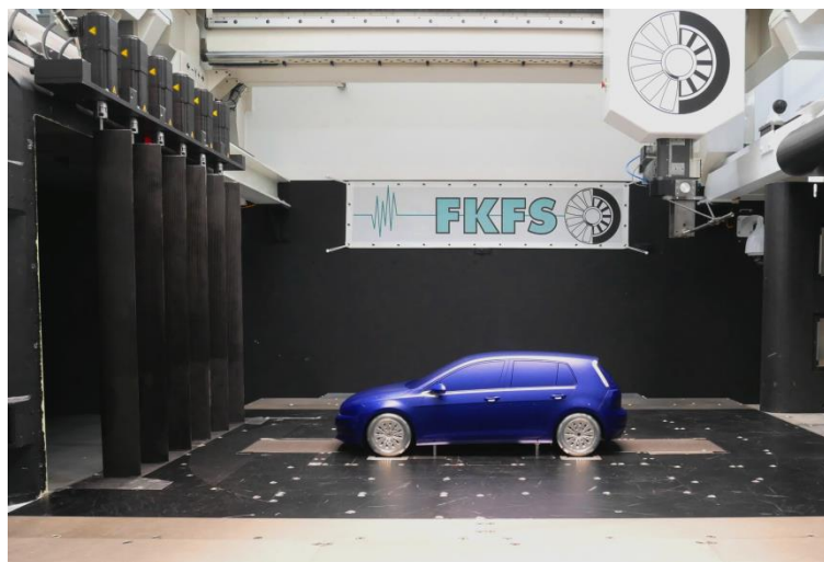
Abbildung 4-13: FAT Golf Fahrzeugmodell im Maßstab 1:4 im Modellwindkanal der Universität Stuttgart mit 5-Band-System und FKFS swing ® in der Düsenaustrittsebene.
