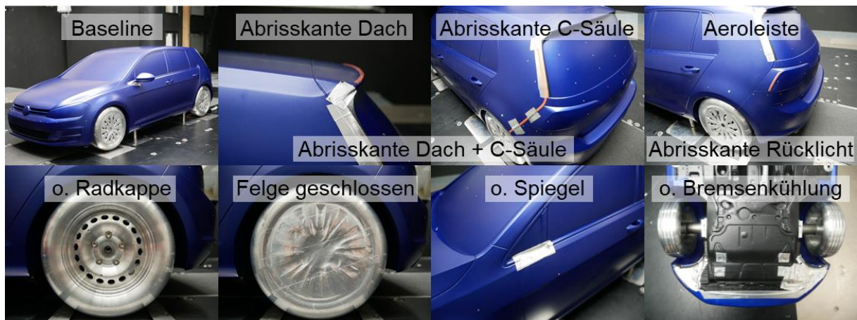
Abbildung 6-15: Detailansicht und Benennung der Varianten der Fahrzeuggeometrie im Windkanal.
