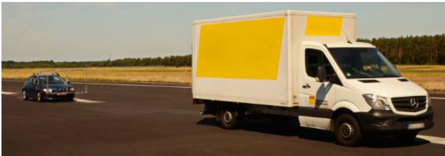
Abbildung 4-10: Hinterherfahrt des Versuchsfahrzeugs mit einem Abstand von 10 m zum Transporter mit Kofferaufbau.
