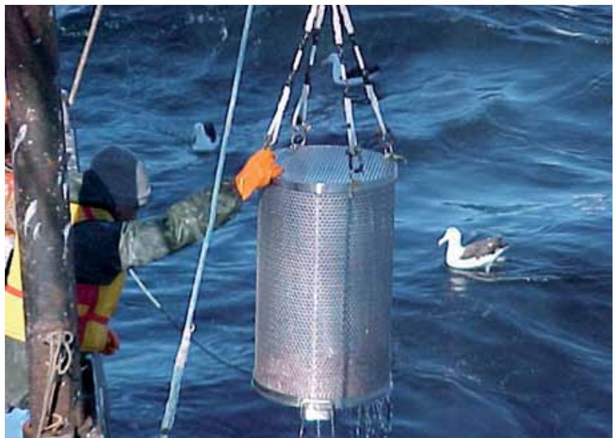
Liberación de los ejemplares con el Dispositivo de liberación de langostinos marcados (DLLM)
