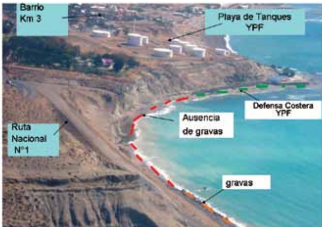
Fig. 3: Playa Del Puerto: - - - - Sector con defensa costera, - - - - Sector con ausencia de gravas, el más vulnerable a la erosión, - - - - Sector permanentemente cubierto con gravas.
