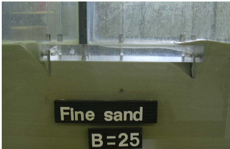
Abb. 9: Fortgeschrittener Erosionsvorgang beim Modell mit Spundwänden (Unterwasserseite rechts)
