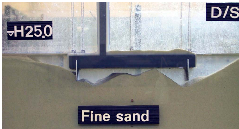
Abb. 10: Endzustand nach dem Tragfähigkeitsverlust durch rückschreitende Erosion
