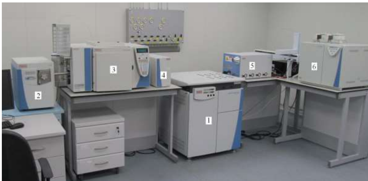
Рисунок 1. Изотопный масс-спектрометрический комплекс (ТомЦКП СО РАН, ИМКЭС): 1- IRMS – изотопный масс-спектрометр DELTA V Advantage; 2 - ICG – квадрупольный масс-спектрометр, позволяющий идентифицировать органические соединения и проводить их количественный анализ; 3 - GC/C/TC – газовый хроматограф, соединенный с окислительным реактором и пиролизатором; 4 - ConFlo – интерфейсный блок для соединения приборов; 5 - GasBench – универсальный прибор для определения карбонатов и исследования водных образцов; 6 - EA, TC/EA – элементный анализатор и пиролизатор.
