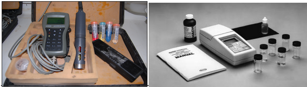
Figura 13. Equipo de campo: HANNA multiparamétrico y turbidímetro HACH
