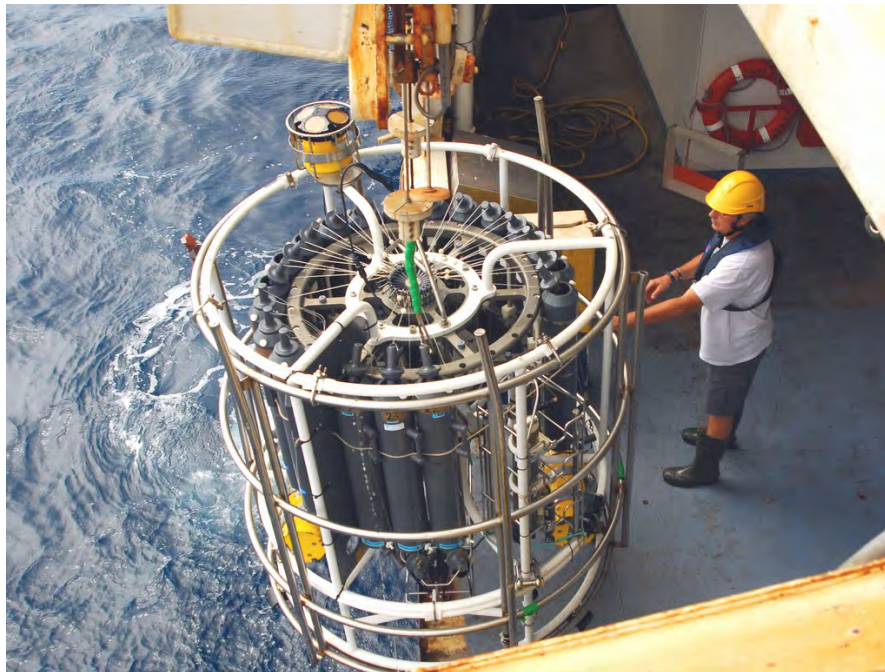
Figura 4.2.2. Recuperando la roseta de 24 botellas desde el pórtico de hidrografía del B/O Thalassa durante la campaña INDEMARES 0710.
