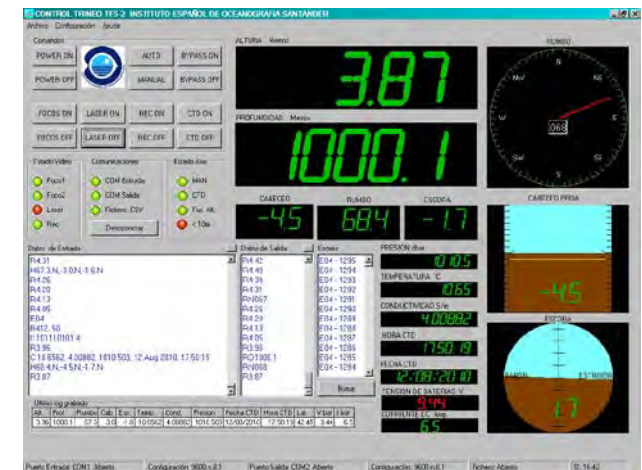
Figura 4.10.5.- Largando el trineo de fotogrametría TFS-2 desde el pórtico de hidrografía del B/O Thalassa . Pantalla del programa de control de vuelo y registro de datos en tiempo real.
