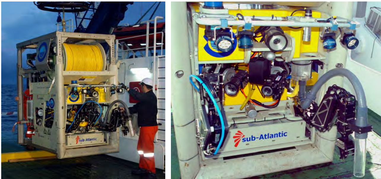
Figura 4.10.1- A) Recuperación del ROV Liropus 2000 , situado en el interior de su TMS, y B) detalle de la disposición de cámaras y focos durante la campaña A0412.
