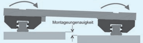
Linearführung in O-Anordnung
