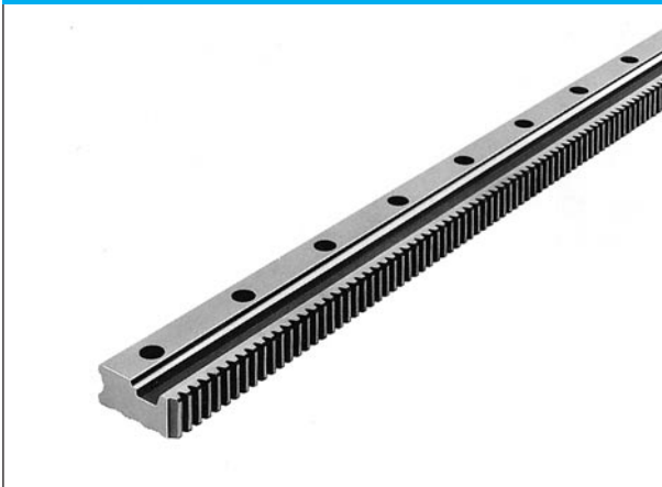
Zahnstange und Führungsschiene sind aus einem Stück gefertigt. Daher ist eine Konstruktion mit einem Antrieb auf kleinem Raum verfügbar (siehe Kapitel GSR-R).
