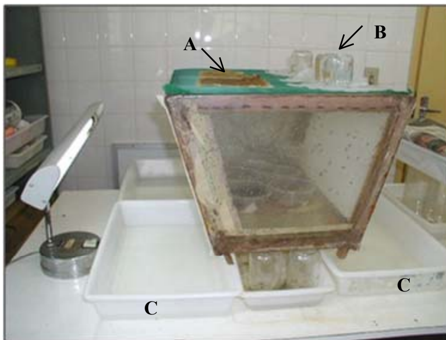
Figura 1. Gaiola de criação de Ceratitis capitata . A. Dieta do adulto, B. Frascos com água, C. Bandeja para coleta de ovos.
