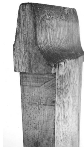
Bild 1/4 Verschlossener Holzzahn eines Göpelantriebes
