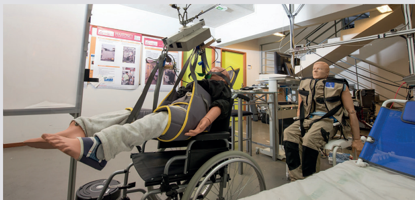
MARIONET-ASSIST, robot paralelo accionado por cable para asistir a personas con movilidad reducida - © Inria_ Photo H. Raguet
