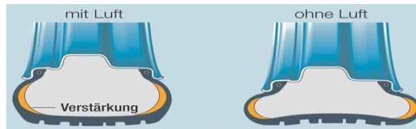
Reifen mit selbsttragender Karkasse
