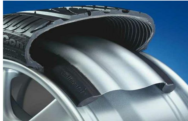
Metallring mit Gummilagerung im Standardreifen als Stützelement beim Pannenlauf (Continental)
