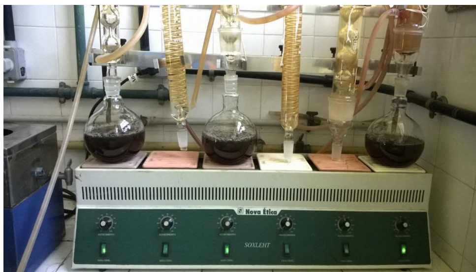
Figura 23. Solução para determinação de lignina sob aquecimento e refluxo.
