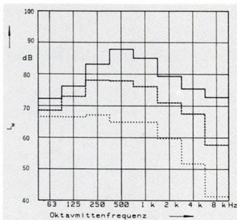
**Bild 2:** Schalleistungsspektrum einer umströmten Schalldämpferkulisserie aus  $\lambda/4$ -Resonatoren
