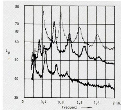
**Bild 3:** Schalldruckspektrum eines durchströmten Kühlers Bandbreite 5 Hz
