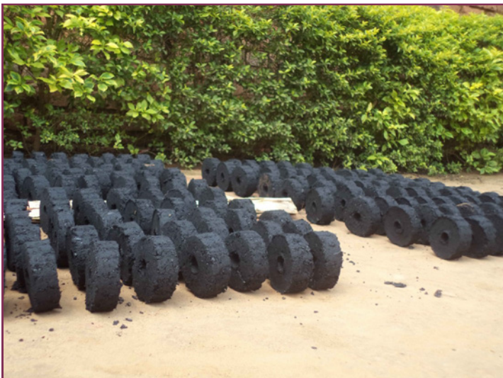
Figura 2. Briquettes : biocombustibile prodotto con rimanenze di piante e altri materiali naturali (Foto di C. Sometti).
