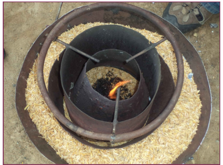
Figura 3. Mayon turbo stove : fornello alimentato con pula di riso che evita l'uso di combustibili tradizionali quali legno o carbone (Foto di C. Sometti).
