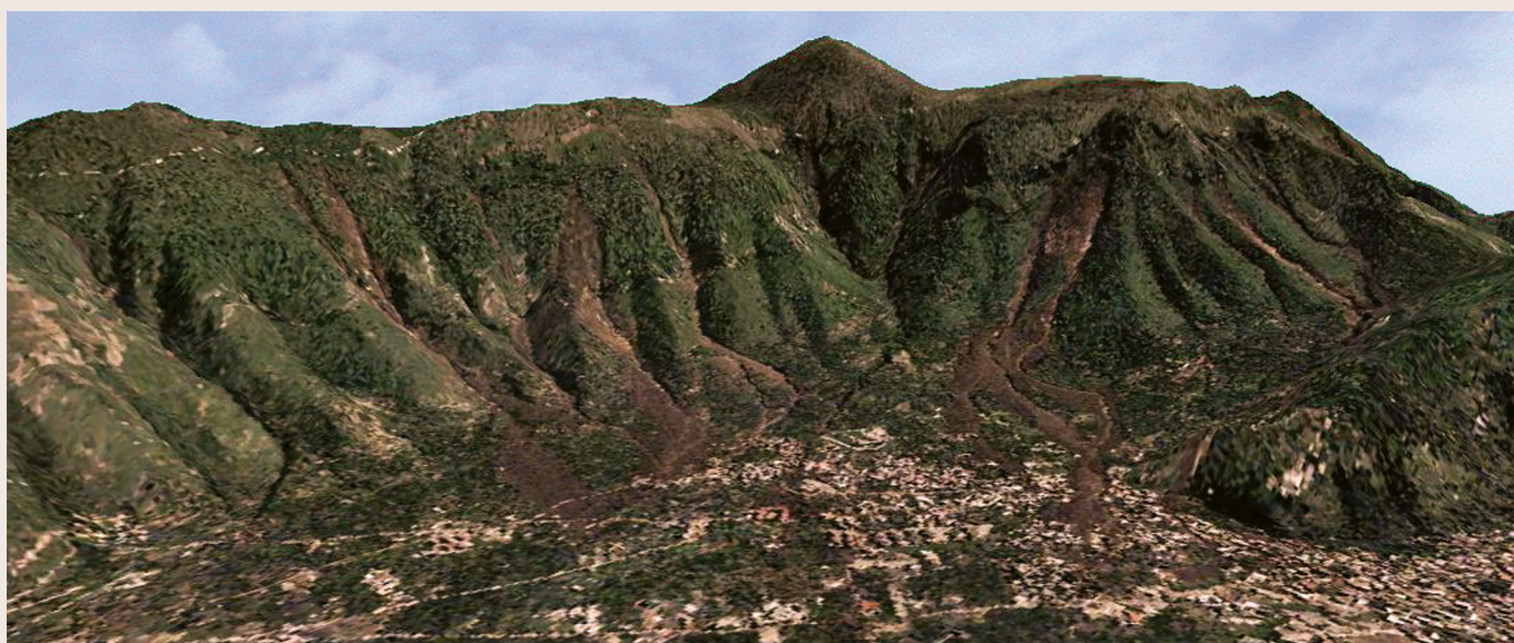
Fig. 3.30 - (in alto) Colate rapide (in verde) innescatesi in Valle d'Aosta a seguito delle intense precipitazioni dell'Ottobre 2000. Si noti la corrispondenza, in diversi casi, delle aree d'innescio con i tagli delle strade forestali. (in basso) Sarno, colate rapide del maggio 1998.
