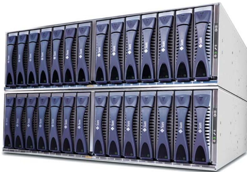
Sun StoreEdge 6120 Array представляет собой модульную платформу с массивом емкостью до 12 Тбайт
