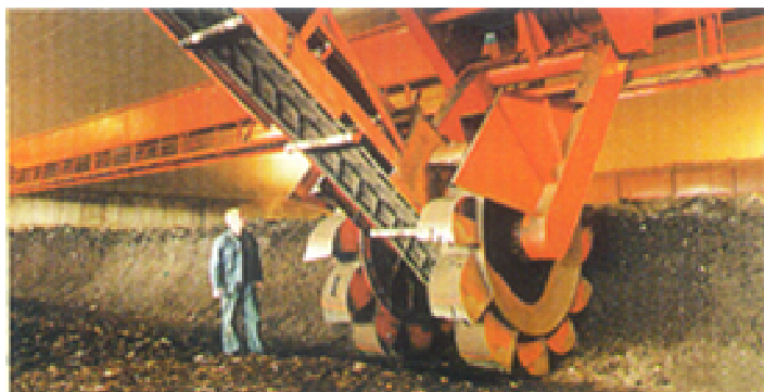
Σχήμα 3-9 Σύστημα τράπεζας κομποστοποίησης
