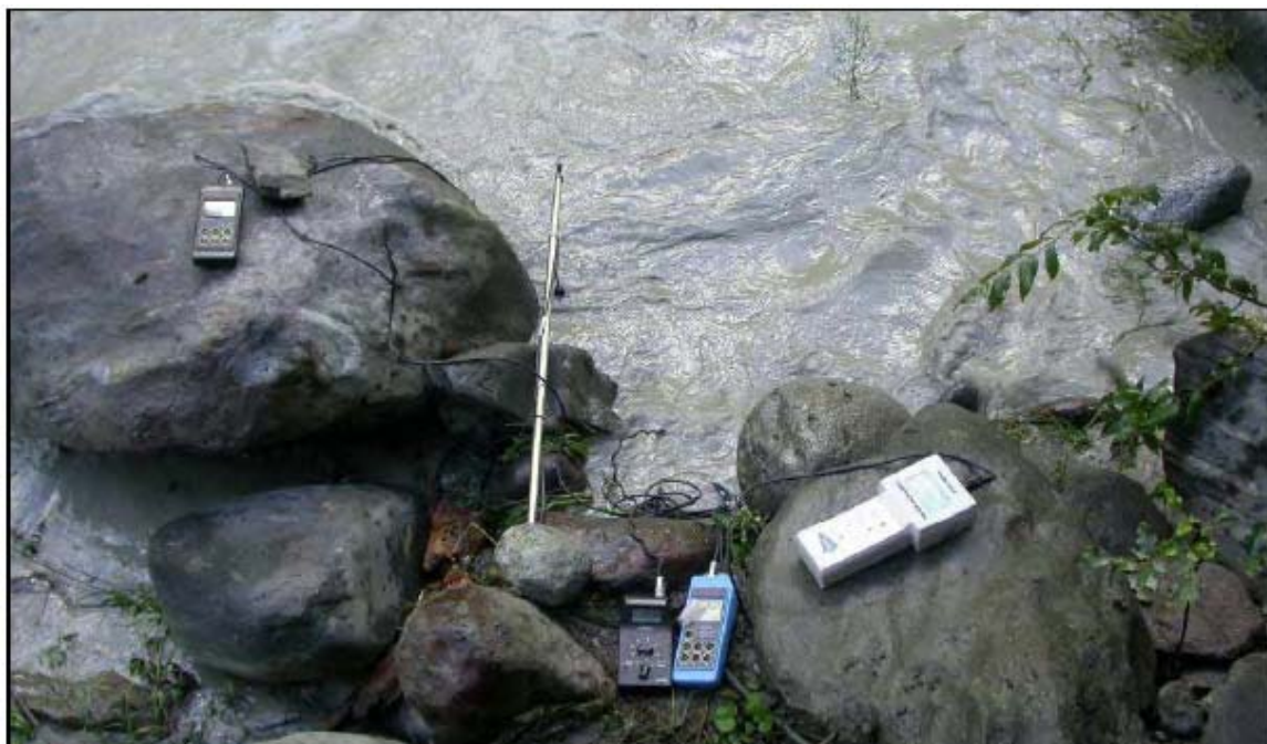
Figura 22.37 - da sinistra a destra: sonde portatili per la misurazione di pH, conducibilità, ossigeno disciolto e solidi sospesi.
