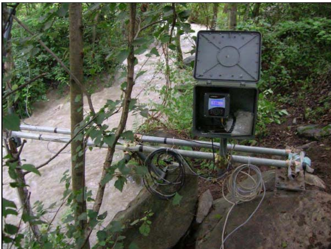
Figura 22.38 - sonda fissa per la misurazione dei solidi sospesi.
