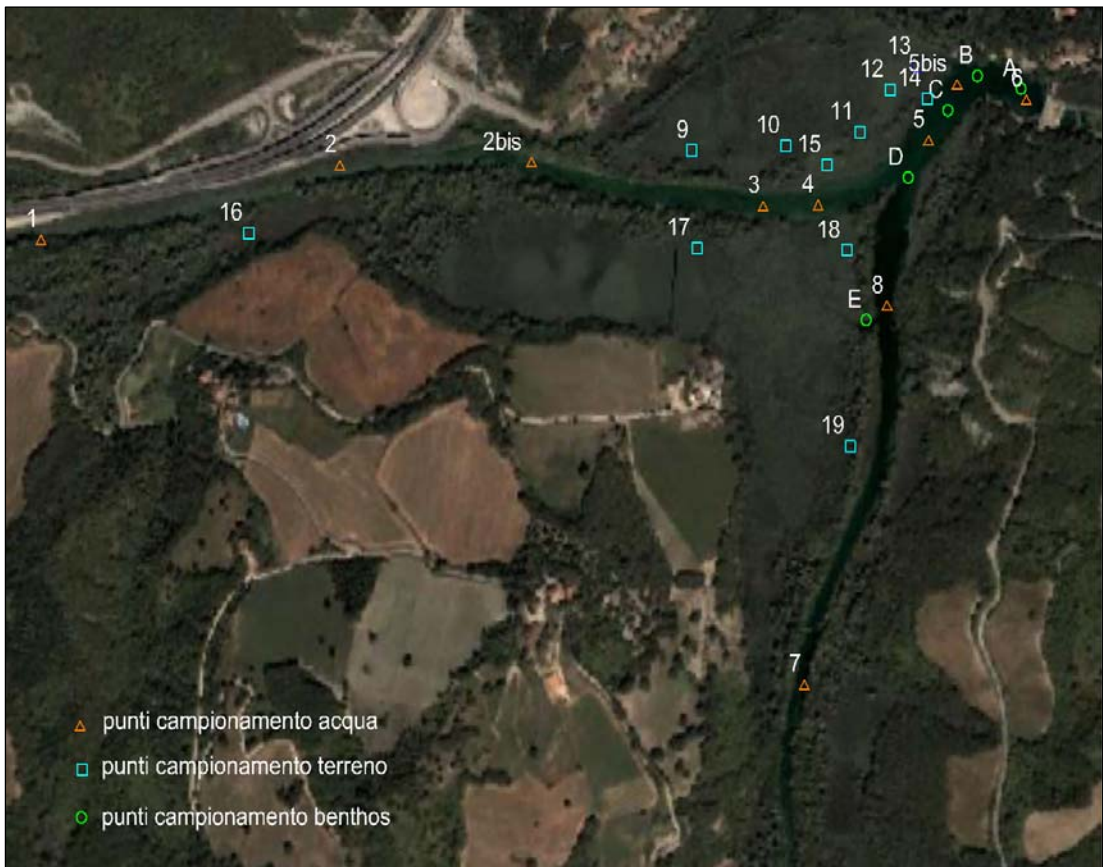
Figura 22.4 – Ubicazione dei punti di campionamento dell'acqua, del terreno e del benthos
