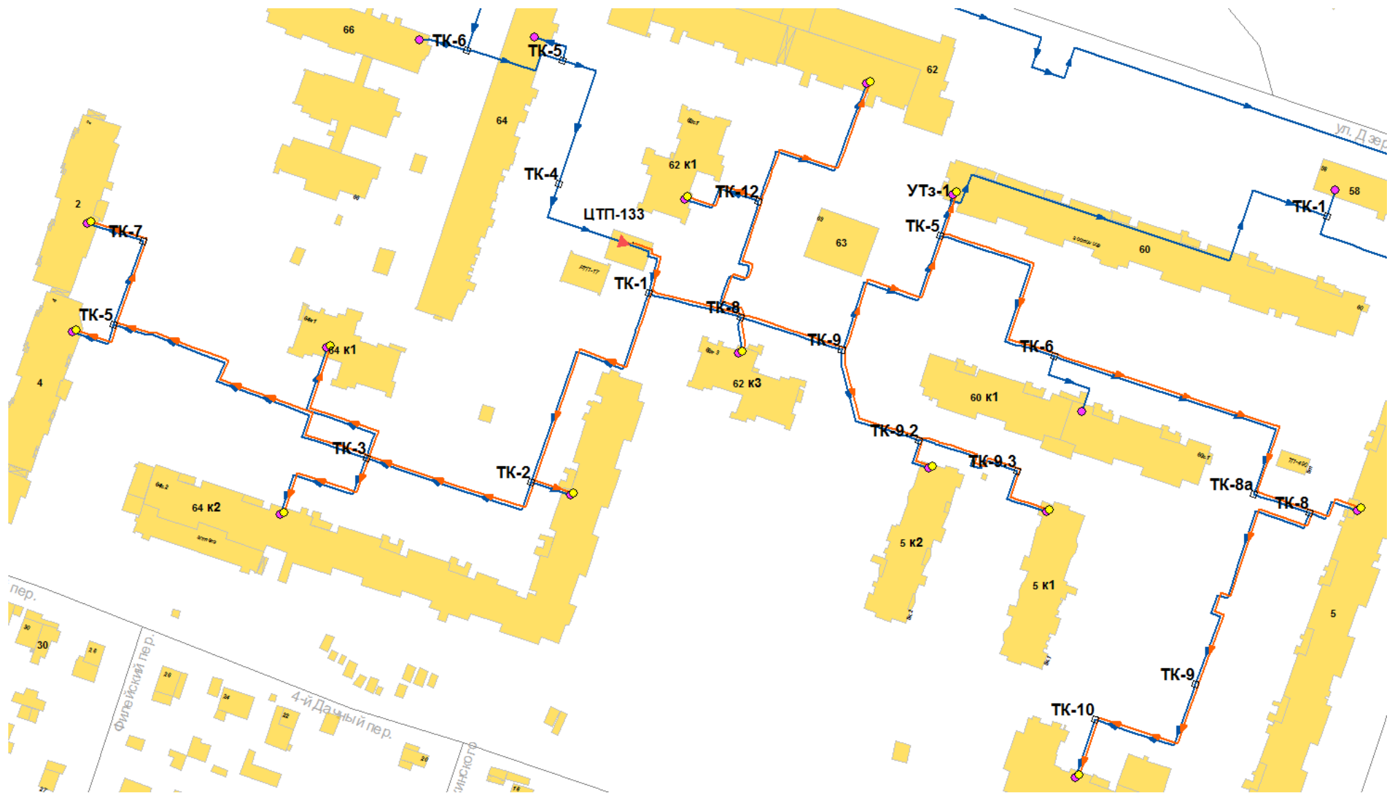
Рис. 4.2.2. Пример реализации присоединения тепловой нагрузки отопления потребителей по Схеме № 2 с элеваторным присоединением и нагрузки ГВС потребителей по закрытой схеме с подачей нагретой водопроводной воды потребителям от ЦТП-133 в г. Кирове
