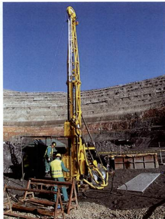
Fotografía 1: Máquina similar a la que se utilizará para los sondeos en el PI Salomé
