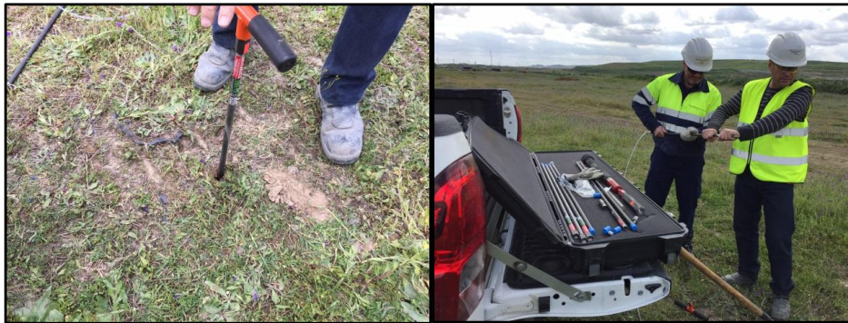
Figura nº 8. Punto de lectura a través de la sonda de absorción y equipo durante el montaje del mismo.
