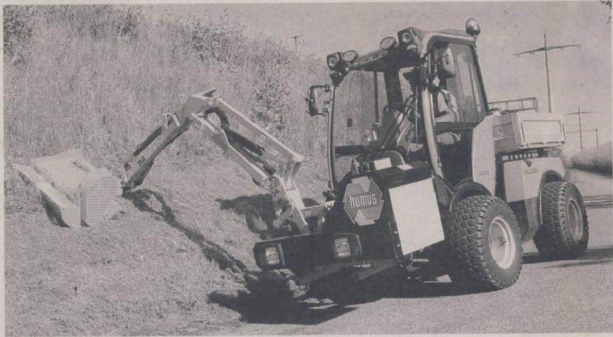
Drei genormte Anbau Räume (Front- und Heckaushebung sowie eine dritter Anbauräum für Aufsattelgeräte) ermöglichen das unkomplizierte Anbringen diverser Anbaugeräte zum Mähen unterschiedlichster Rasenflächen, zum Mulchen, Kehren, dem Reinigen von Kunstrasen u. v. m.
