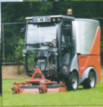
Der Citymaster 600 von Hako ist ein kompakter, knickgelenkter sowie multifunktionaler Geräteträger
