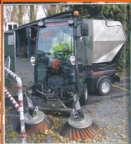
Die X 30 von Holder verfügt über 27 PS, ein Kehr-Saugsystem sowie 1000-Liter-Behältervolumen
