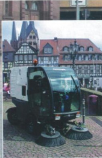
Die Nilfisk RS 502 von schafft dank eines Vierzylinder-Diesels Steigungen von bis zu 22 Prozent
