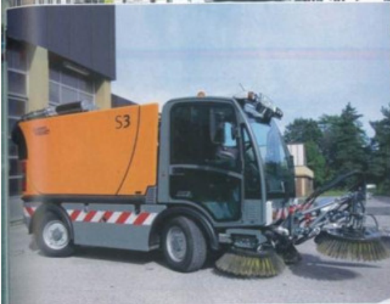
Die S3 von Küpper-Weisser besitzt Optionen wie eine frontseitige Schwemmanlage
