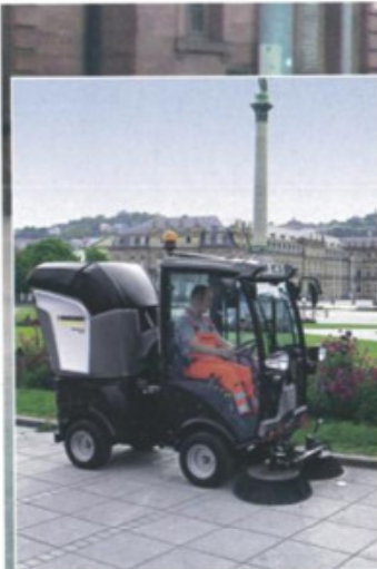
Kärchers MC 50 gibt es in zwei Varianten: Die „Classic“ ist reine Kehrmaschine, die „Advanced“ besitzt Optionen auf Schwemmanlage, Schneepflug oder dritten Besen
