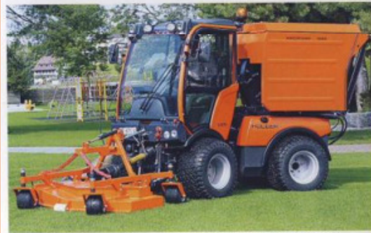
Holder-Universalgeräteträger mit einer Mäh-Saug-Kombination (Rasenbereifung 31 x 13,50-15 mit Radaußenbreite ab 136 cm). Der C 250 verfügt über eine Leistung von 50 PS (36,5 kW) und einen permanenten Allradantrieb sowie hydraulischen Radlastausgleich. Zu den weiteren Kennzeichen zählen gefederte Vorder- und Hinterachsen, eine mechanische Differenzialsperre (100 % Sperrwirkung) sowie eine voll-hydrostatische Knicklenkung. Die Kabine ist hydraulisch kippbar.
