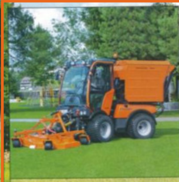
Der Holder C 250 ist eine Arbeitsmaschine mit Knicklenkung. Sie sorgt für spurtreues Fahren
