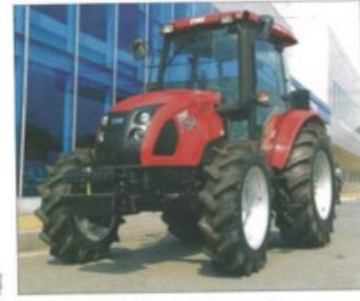
Neuer Tym T 743 mit 74 PS Deutz Motor.
