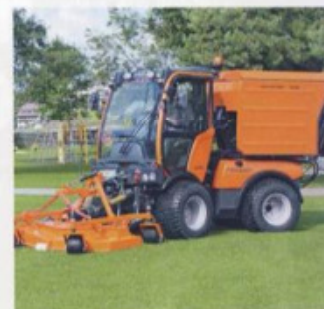
Holder-Universalgeräteträger mit einer Mäh-Saug-Kombination. Foto: Max Holder GmbH
