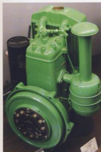
De tweetakt dieselmotor van Holder: 500 cm 3 , vermogen 10 pk.
