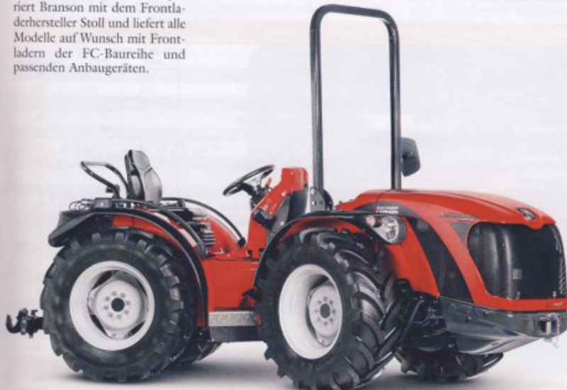
Der SRH 9800 Infinity von Carraro ist ein Knicklenker mit 87 PS.
