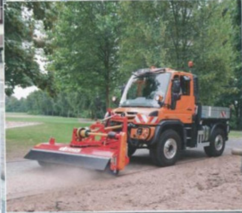
Der Unimog von Mercedes-Benz kann mit vorn befestigter Anbaukehrmaschine oder hinterm Fahrerhaus montiertem Kehraufbau benutzt werden
