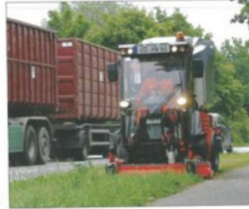
Der Hako Citymaster 1250C ist ein Knicklenker mit 35 PS.
