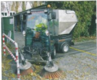
Der Holder X30 ist ein vielseitiger Geräteträger, hier im Kehrsaugensatz.
