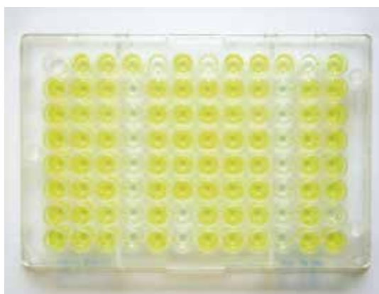
Slika 4.4: Primer mikrotitrne ploščice z dobro vidno barvno reakcijo v luknjicah z okuženimi vzorci ob koncu testa ELISA (avtor I. Mavrič Pleško)
