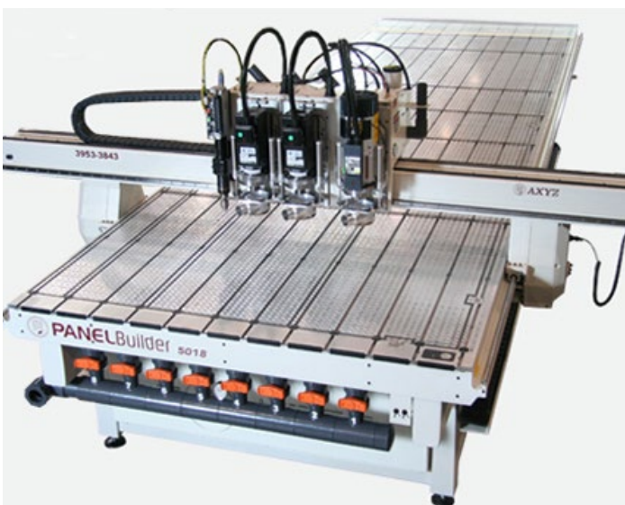
Abb. CNC Bearbeitungszentrum, Panel Builder von XYZ International
