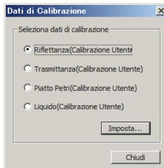
**2-2)** Se è stata selezionata l'opzione Riflettanza (Calibrazione Utente), selezionare l'area di misura e il modo componente speculare che si desidera impostare.
