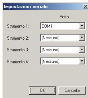
Quando si collega una o più unità CM-700d/600d, la modalità componente speculare (SCI, SCE o SCI+SCE) e l'area di misura (SAV (3 mm) e MAV (8 mm)) specificate per il primo strumento collegato (strumento 1) vengono applicate agli altri strumenti collegati.
