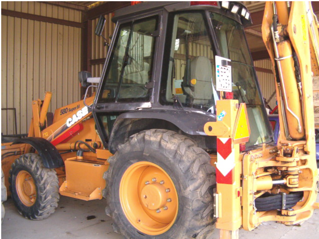
Fot. nr 11. Koparko-ladowarka służąca m.in. do załadunku gruzu podczas kruszenia.
