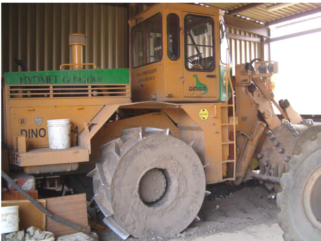
Fot. nr 12. Kompaktom – DINO DZO-4 do zagęszczania odpadów.
