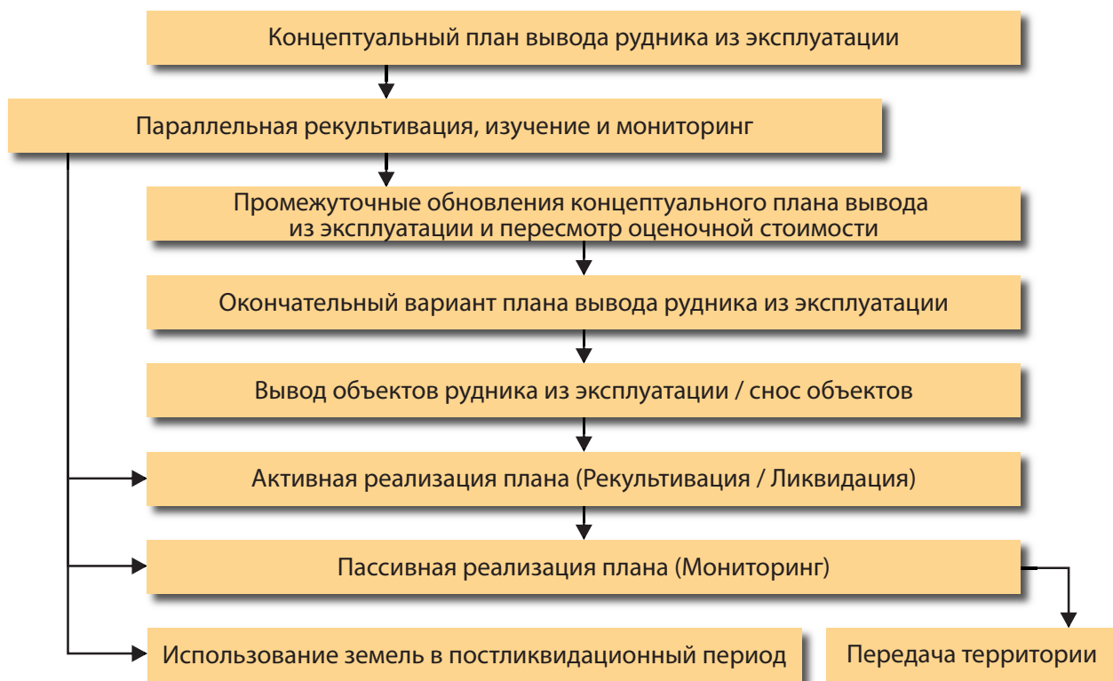
Схема 7-1: Последовательность мероприятий при выводе рудника «Кумтор» из эксплуатации.
