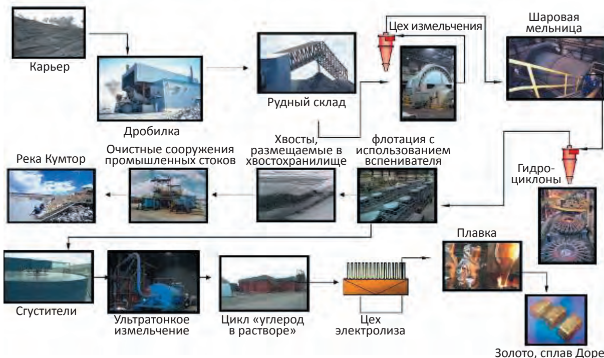
Схема 2-1: Производственный процесс рудника «Кумтор»
