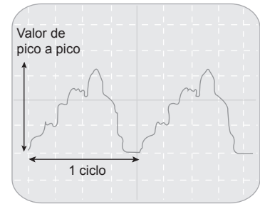
Figura 5.17 Para medir las características de una señal periódica de forma no regular se procede con el osciloscopio de igual manera que en el caso de las señales senoidales.
