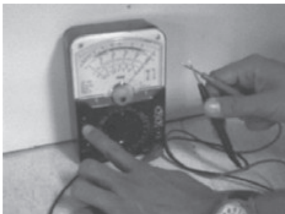
Figura 2.13 Ajuste a cero en un óhmetro analógico. (En el óhmetro digital el ajuste a cero se hace en forma automática).
