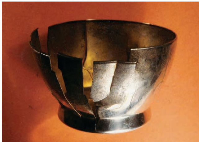
Abb. 5.1: Spannungsrissskorrosion durch Quecksilber Vorbehandlung (Verquicken) vor der galvanischen Versilberung von Messing. Die Rissbildung kann lange nach der Fertigung auftreten
