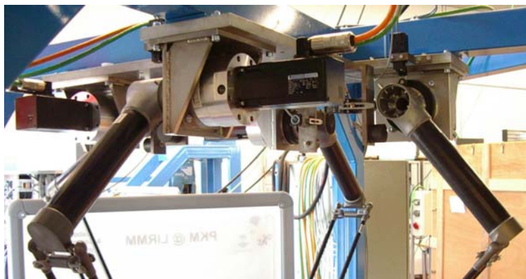
Figure D.11. Photo du robot I4R, détail des actionneurs rotatifs et des capteurs de fin de course
