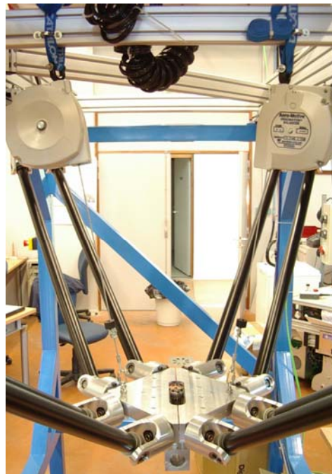
Figure D.7. Photo du robot I4L, détail des compensateurs de gravité
