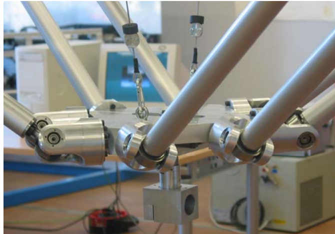
Figure D.5. Photo du robot I4L, détail de la nacelle
