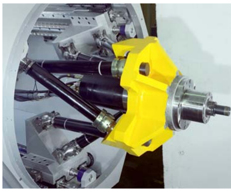
Figure 1.19. Hermes (Fatronik), photo du poignet et graphe d'agencement
