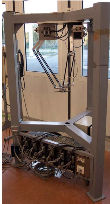
Figure D.2. Photo du robot H4, détail du bâti (pourvu des variateurs)
