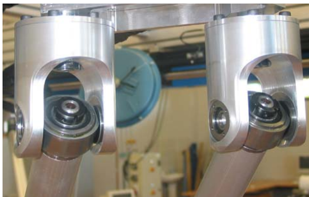
Figure D.8. Photo du robot I4L, détail des rotules INA
