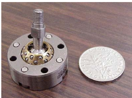
Figure D.12. Photos des rotules Hephaist du robot Eureka
