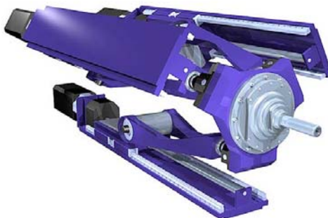
Figure 1.18. Sprint Z3 (DS Technologies), image CAO du poignet et graphe d'agencement
