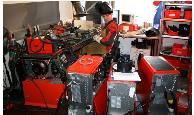
Bild 16: Optimierung von Kennlinien- und „Dynamics“-Parametern im Schweißlabor
