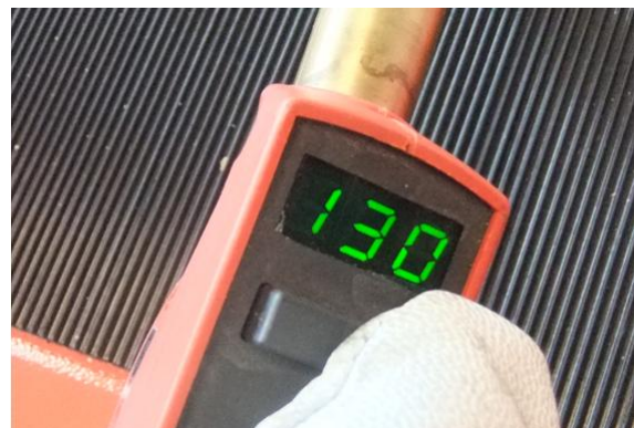
Bild 14: Verstellung des „Dynamics“-Parameters am Brenner. Das ist auch während des Schweißens möglich.
