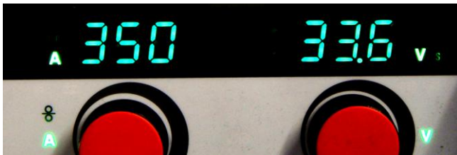
Bild 8: Einstellung des indirekten Führungsparameters Schweißstrom (linker Knopf und Anzeige) und der gewünschten mittleren Schweißspannung (rechter Knopf und Anzeige) bei der Lorch MicorMig mit Basic-Bedienfeld.
